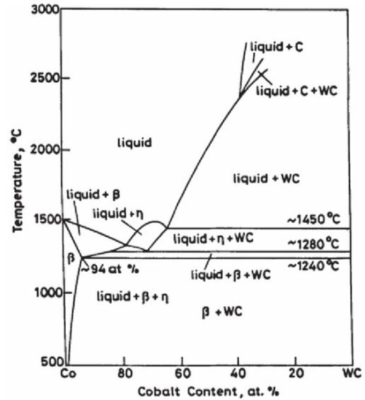
Fig. 4. Phase diagrams tungsten carbide–cobalt
